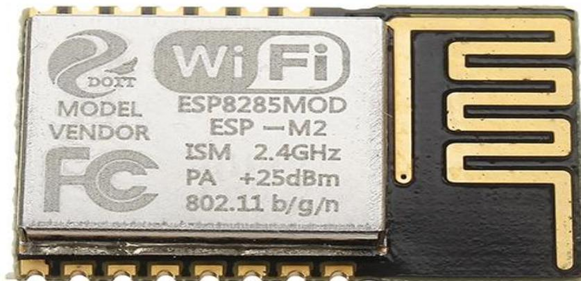
Рис. 2. Wi-Fi модуль ESP-2M
