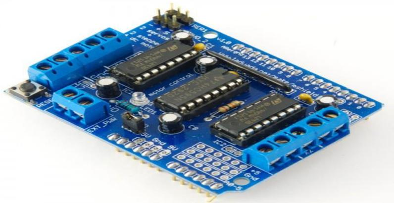
Рис. 1. Плата расширения L293D Motor Driver Shield
