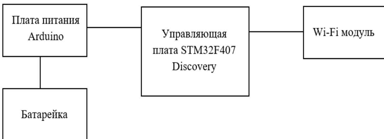
Рис. 5. Структурная схема перчатки управления
