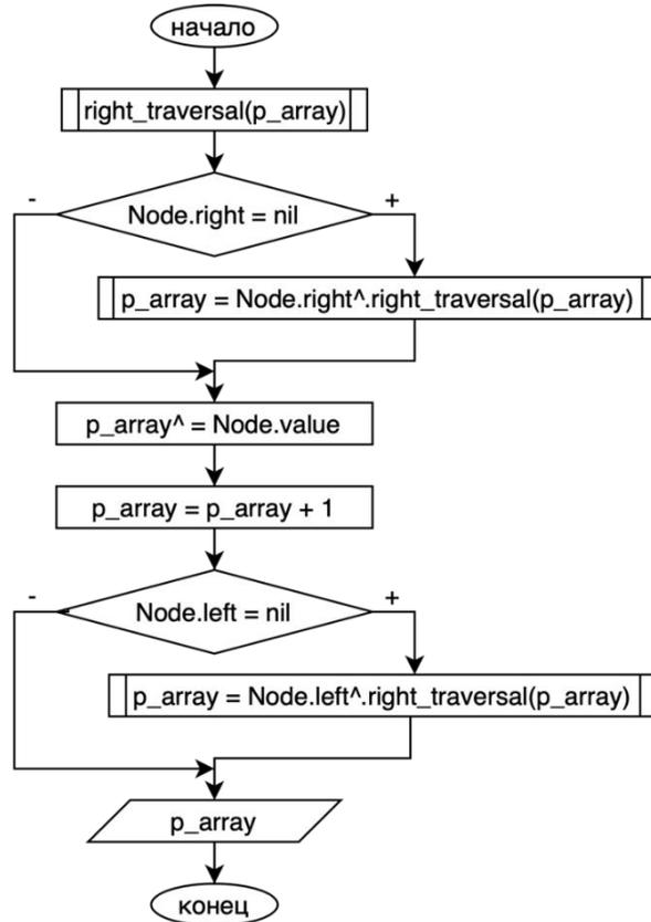
Рис. 10. Блок-схема алгоритма централизованного обхода дерева справа
