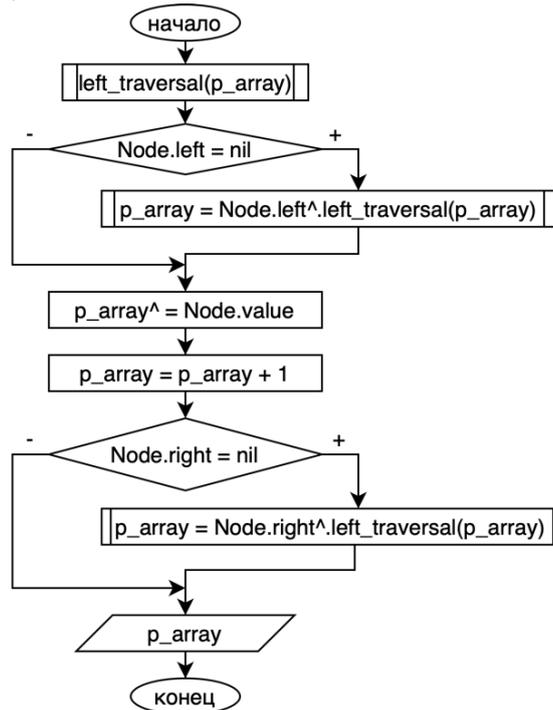
Рис. 9. Блок-схема алгоритма централизованного обхода дерева слева
