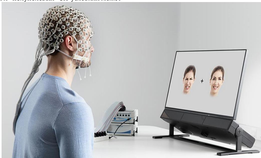
Рис. 2. Комбинированная установка ЭЭГ и слежения за глазами в лабораторных условиях [2]
