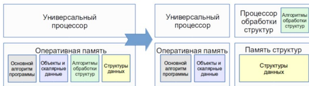
Рис. 2. Вычислительная система с аппаратной поддержкой операций над множествами и структурами данных
