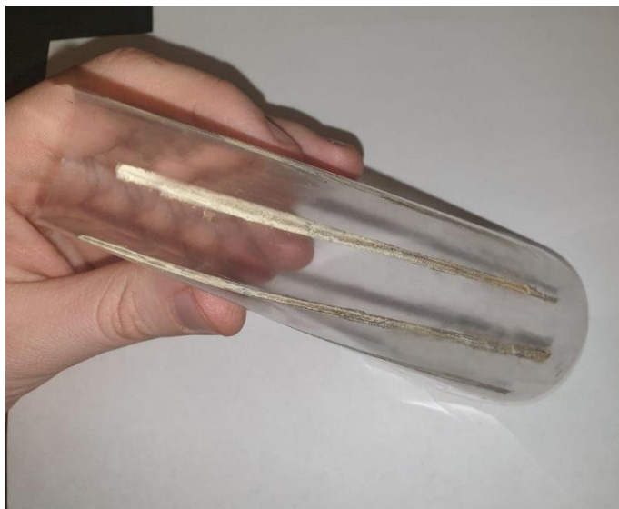
Рис. 5. Напечатанные проводники на струйном принтере
