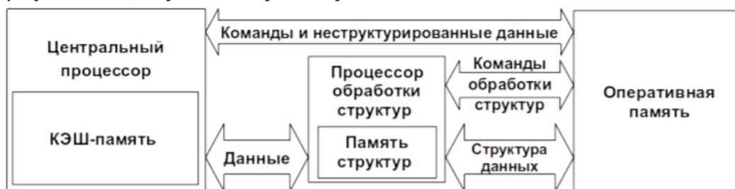
Рис. 3. Взаимодействие устройств в вычислительной системе с аппаратной поддержкой операций над множествами и структурами данных
