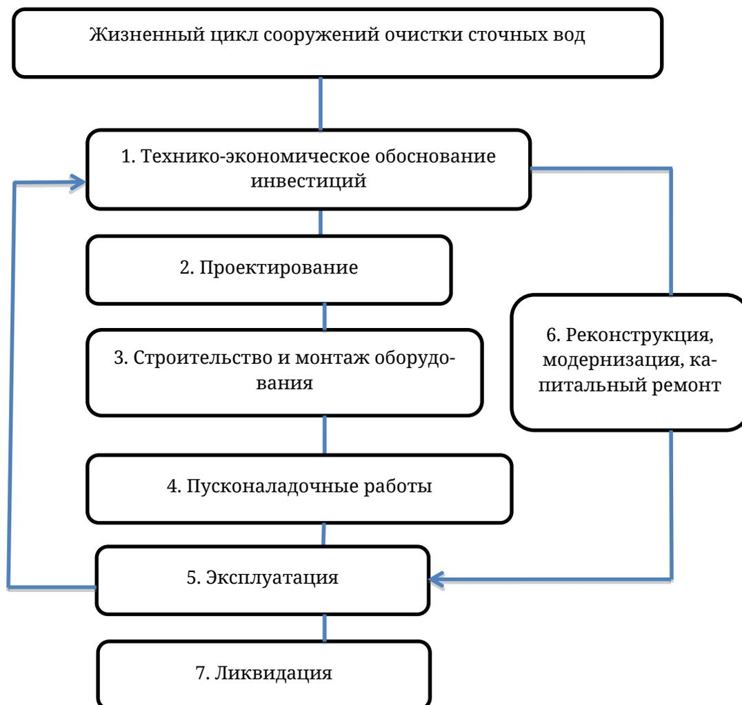
Рис. Этапы жизненного цикла сооружений очистки сточных вод
