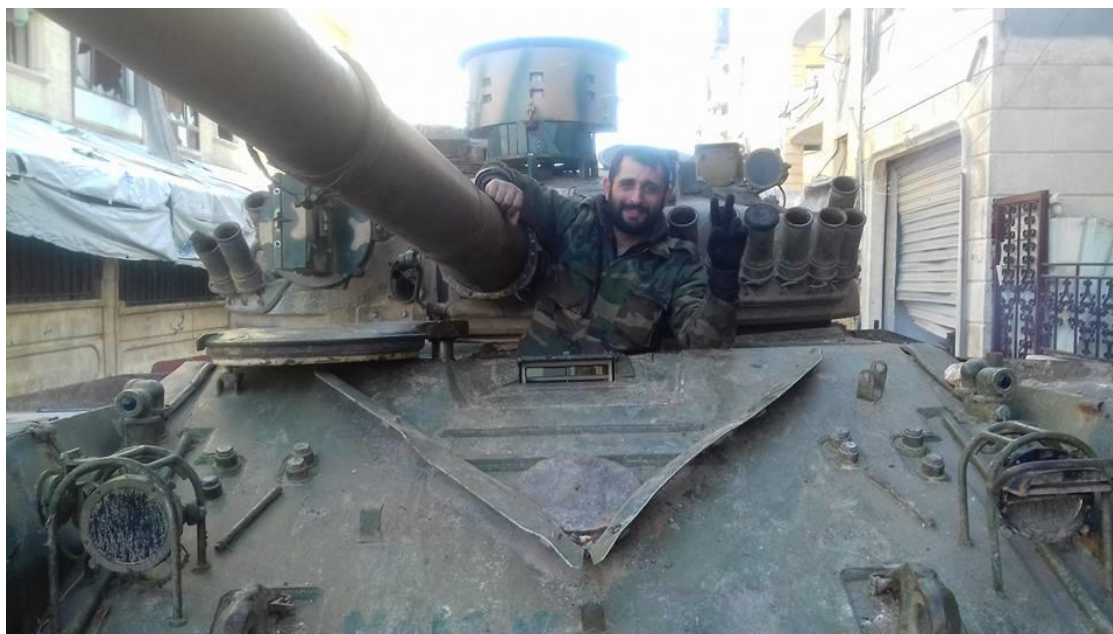
Рис. 2. Сирийский "скворечник" на танке
