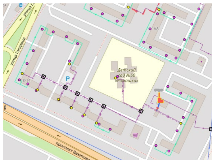
Рис. 1. Расчетная модель тепловой сети г. Нижнекамск в ZuluThermo
