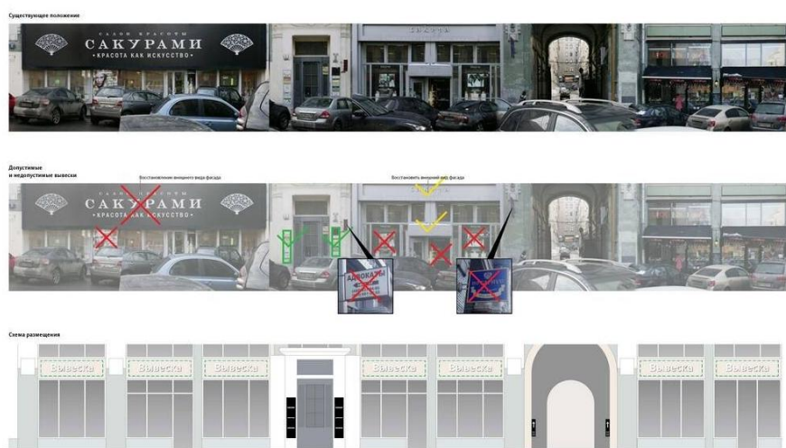
Рис. 8. Пример неправильного и правильного использования визуальных атрибутов на историческом фасаде в брошюре проекта студии А. Лебедева
