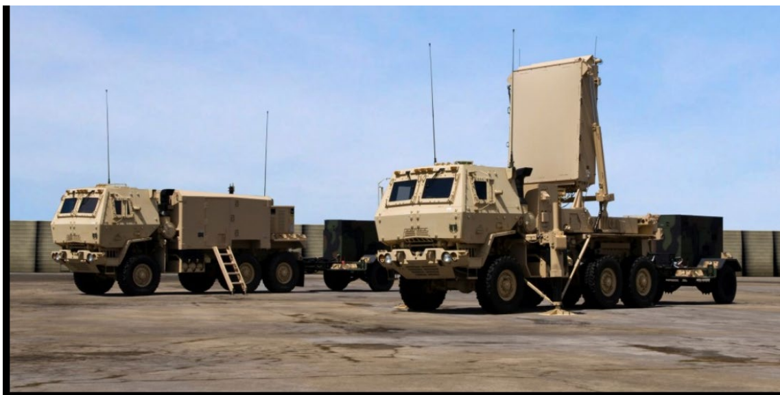
Рис. 30. РЛС контрбатареинной борьбы AN/TPQ-53 в диапазоне 2-4 ГГц
