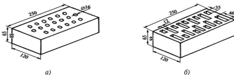
Рис. 2. Кирпич керамический эффективный с пустотами: а – круглыми 19 штук; б – щелевыми 18 штук
