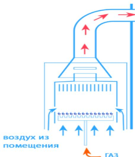
Рис. 1. Схема котла с открытой камерой сгорания
