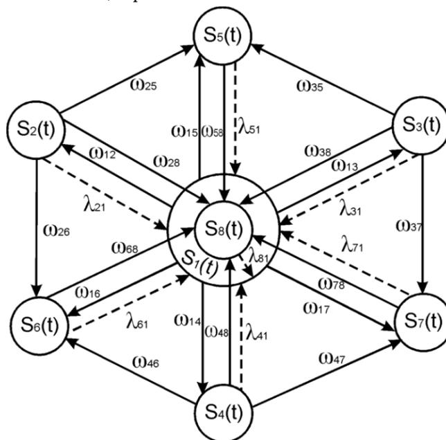
Рис. Граф выхода из строя и восстановления исследуемой системы пожарной техники:  $S_1(t)$  – состояние исправности;  $S_2(t) - S_8(t)$  – состояние исправности агрегатов пожарной единицы;  $\lambda_{ij}$  – параметр, отражающий интенсивность восстановления;  $\omega_{ij}$  – параметр, отражающий поток отказов
