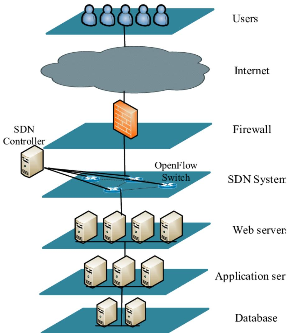
Рис. 1. Архитектура SDN-системы с адаптивной маршрутизацией на основе контроллера OpenFlow
