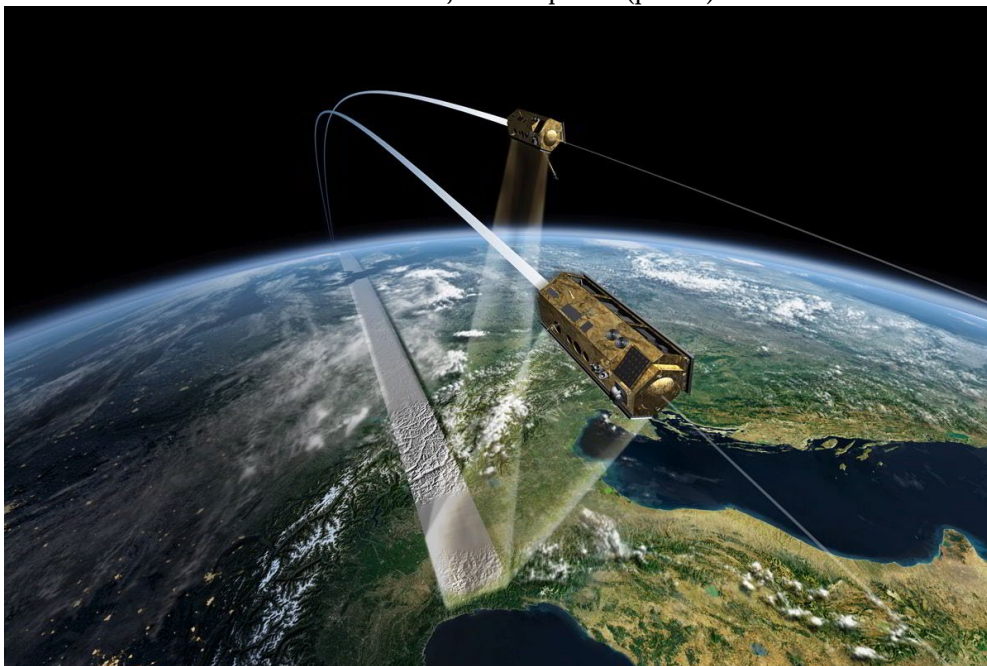
Рис. 2. Радарная интерферометрическая съёмка земной поверхности с борта космических аппаратов высот [11]
