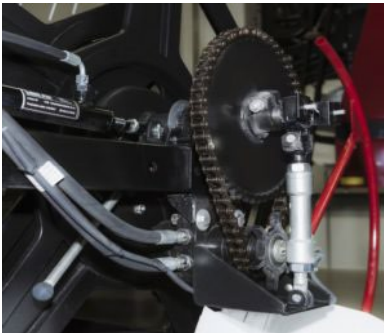
Рис. 2. Привод мотвила от гидромотора
