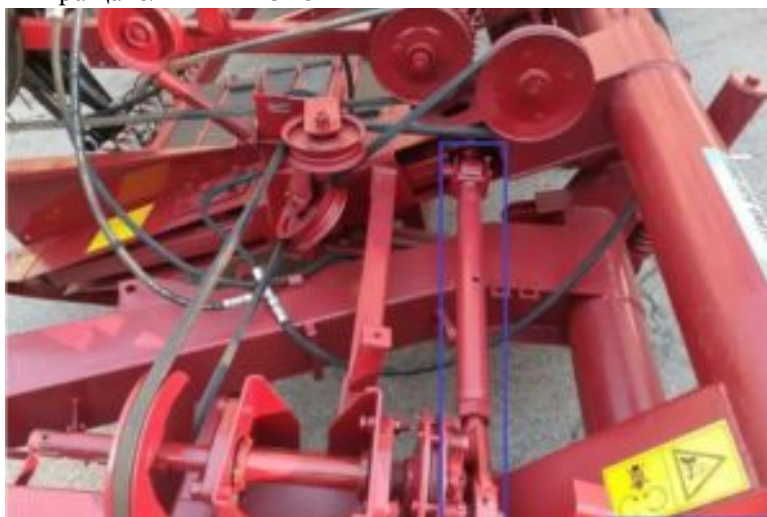
Рис. 1. Система ременного привода жатки ЖВП
