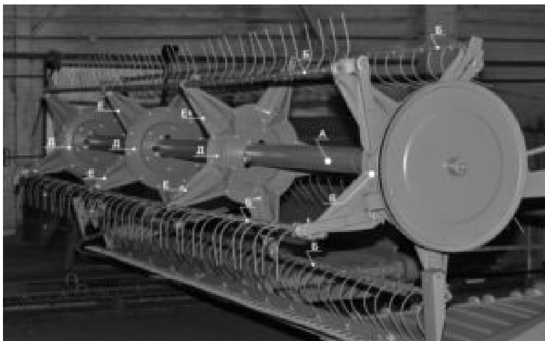
Рис. 3. Мотовила с подающими пальцами на планках
