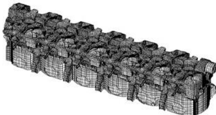
Рис. 1. Сетка системы охлаждения двигателя
