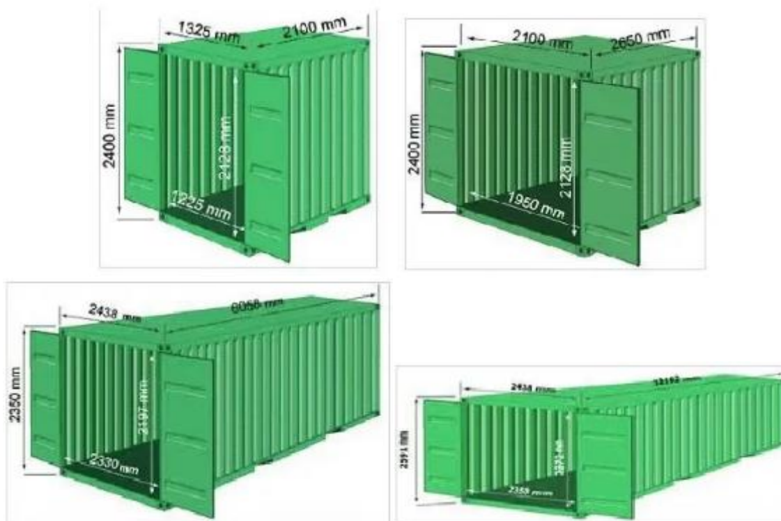
Рис. 2. Виды контейнеров в зависимости от грузоместимости
