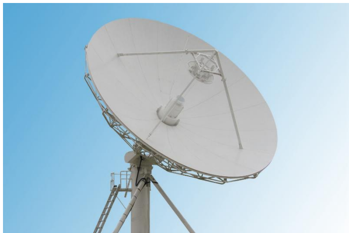
Рис. 1. Зеркальная прямофокусная (осесимметричная) антенна
