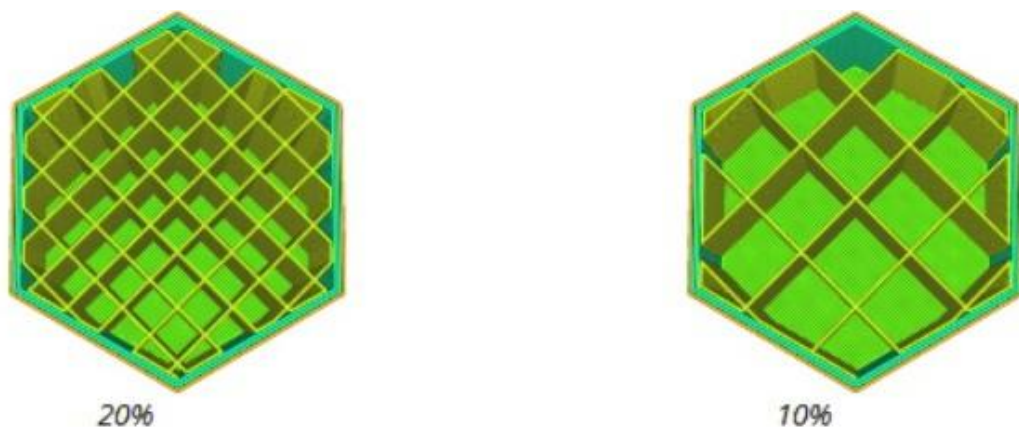
Рис. 1. Пример заполнения детали при 10% и 20%
