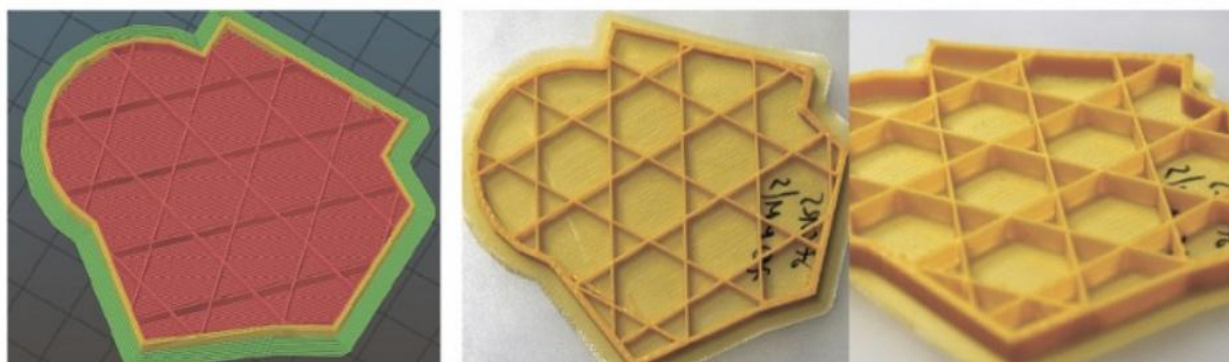
Рис. 4. Треугольно-гексагональное (звёздчатое) заполнение
