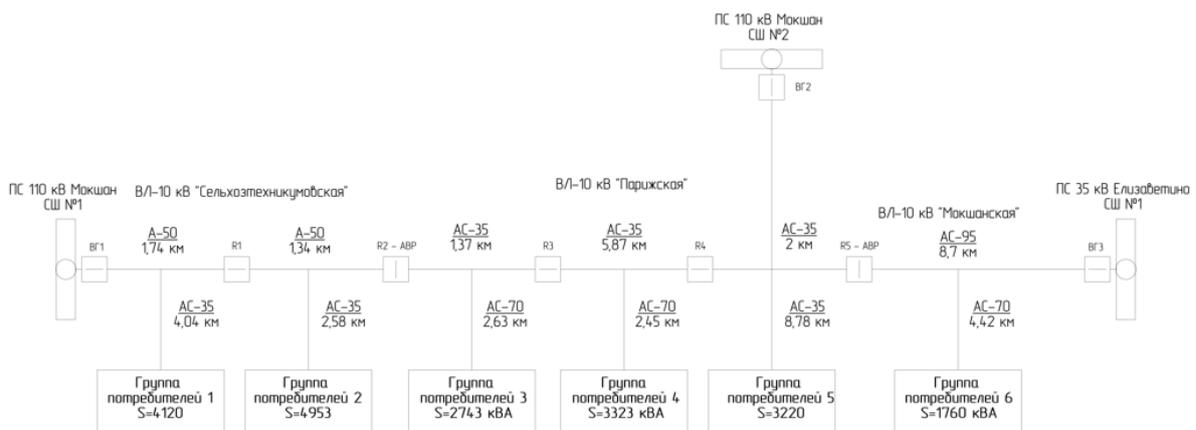
Рис. 3. Упрощенная схема размещения реклоузеров вариант 3
