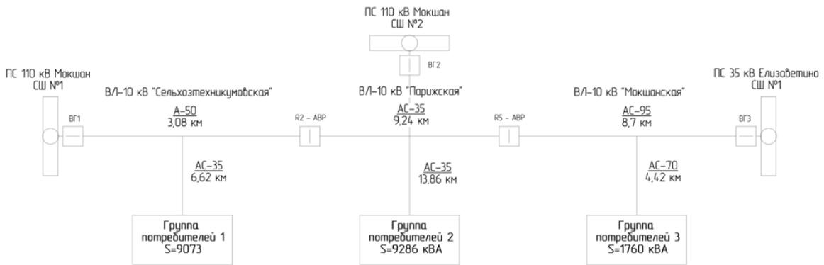
Рис. 1. Упрощенная схема размещения реклоузеров вариант 1
