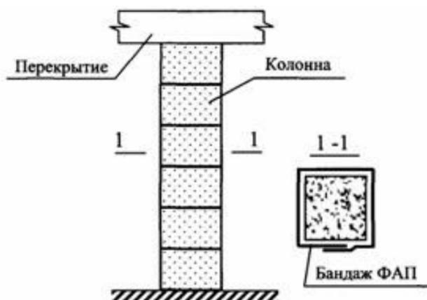
Рис. 1. Принципиальная схема усиления колонны композитными материалами
