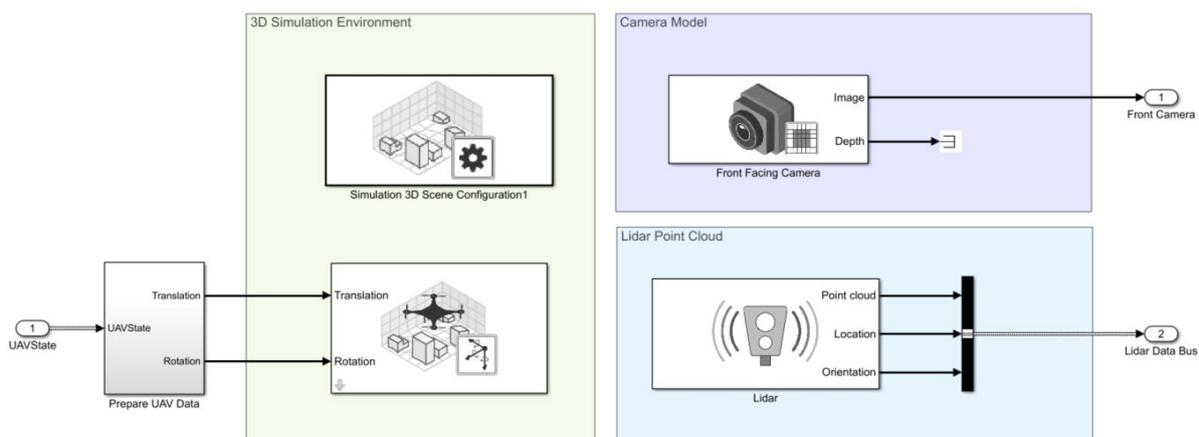
Рис. 3. Датчики квадрокоптера
