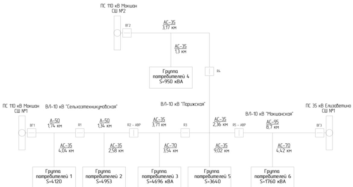
Рис. 2. Упрощенная схема размещения реклоузеров вариант 2
