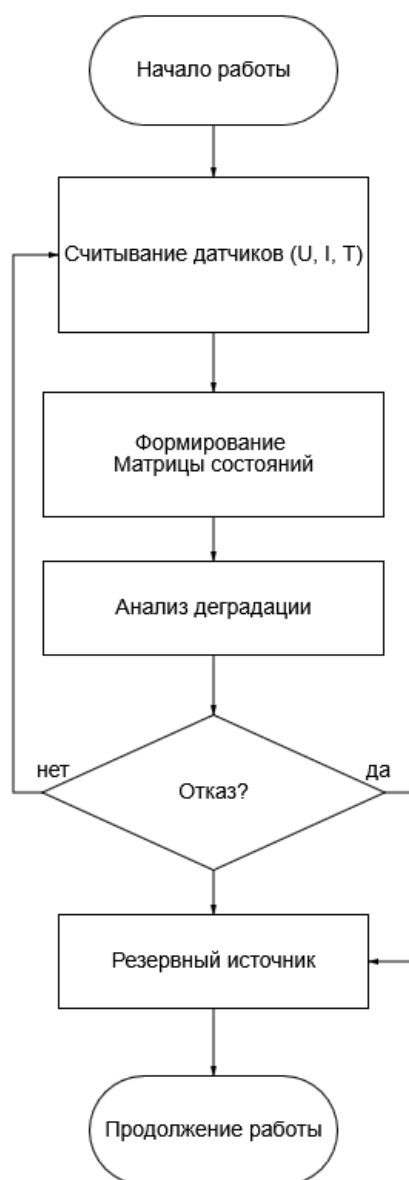
Рис. 2. Алгоритм программного мониторинга гибридной системы управления питанием
