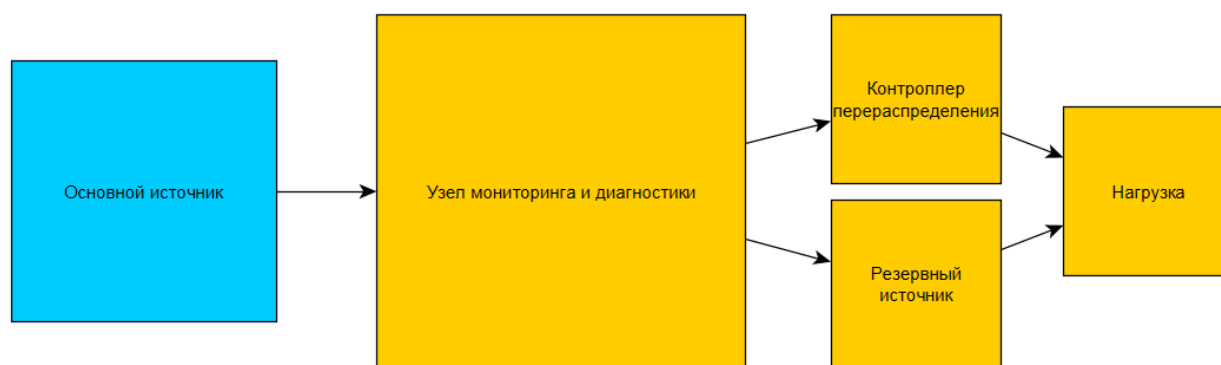
Рис. 1. Структурная схема гибридной архитектуры
