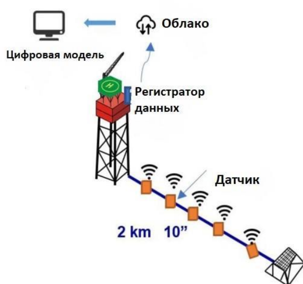
Рис. 4. Расстановка сенсоров и передача больших геоданных для цифрового двойника подводного трубопровода [10]
