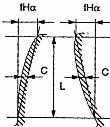
Рис. 4. Вид модификации профилей зубьев:
