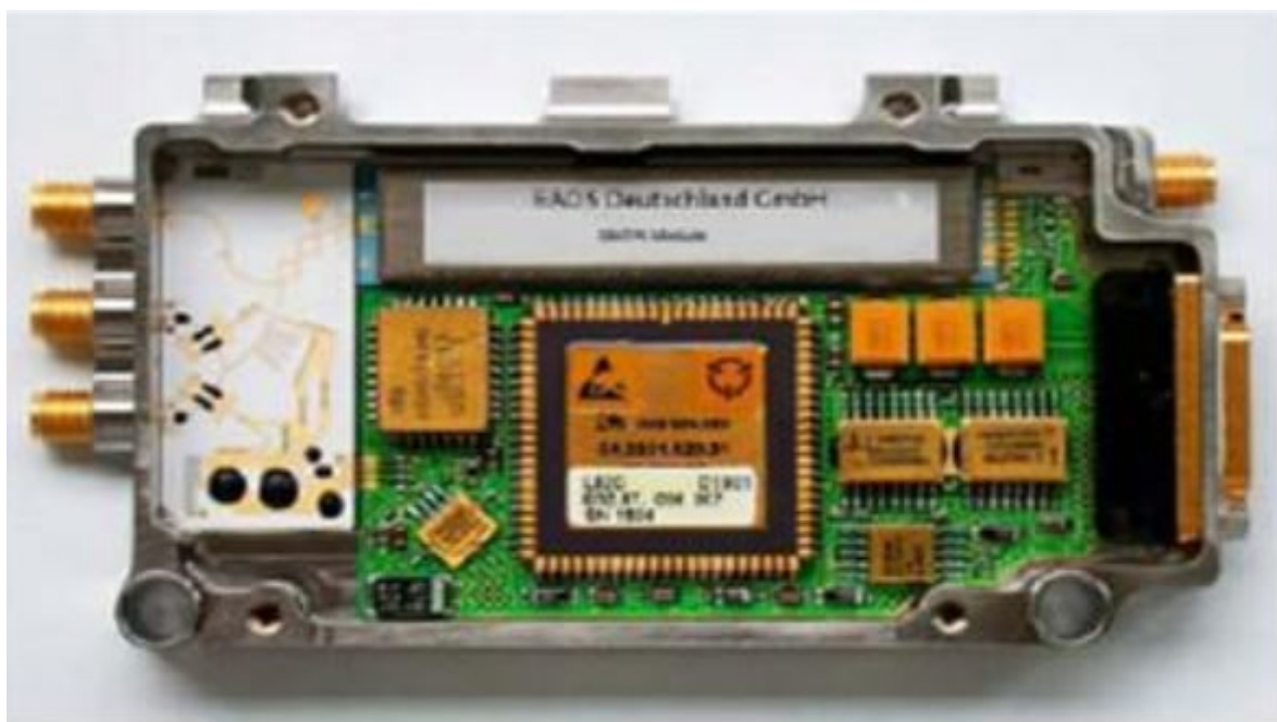
Рис. 14. Модуль СВЧ АФАР X-диапазона
