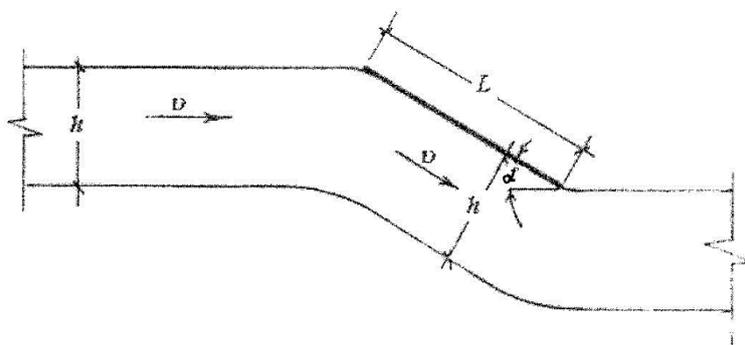
Рис. 3. Схема обтекания пластинки с углом атаки  $\alpha$
