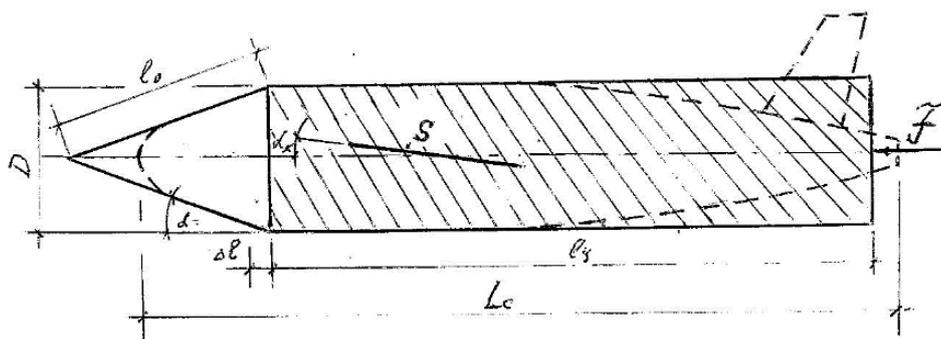
Рис. 6. Схема воздушного судна и виртуального цилиндрического судна
