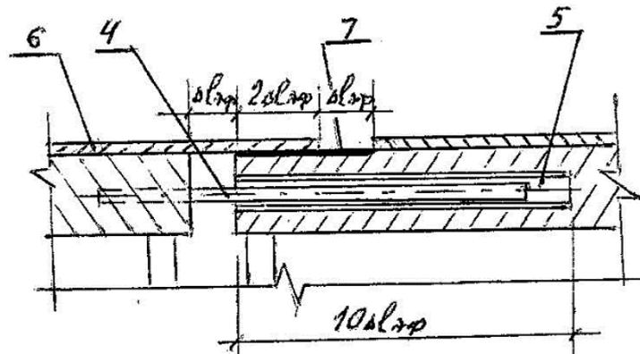
Рис. 10. Узел А пальцево-втулочного соединения частей корпуса
