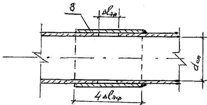
Рис. 11. Узел Б соединения труб защитного кожуха
