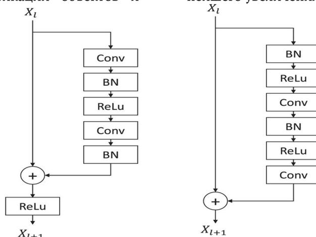
Рис. 3. Структура ResNet и улучшенная структура ResNetV2
