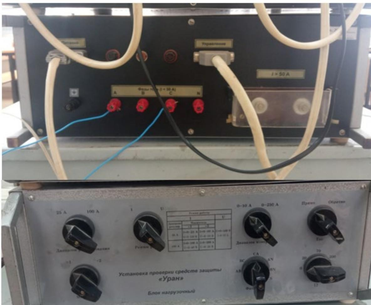
Рис. 2. Пример подключения нагрузочного блока
