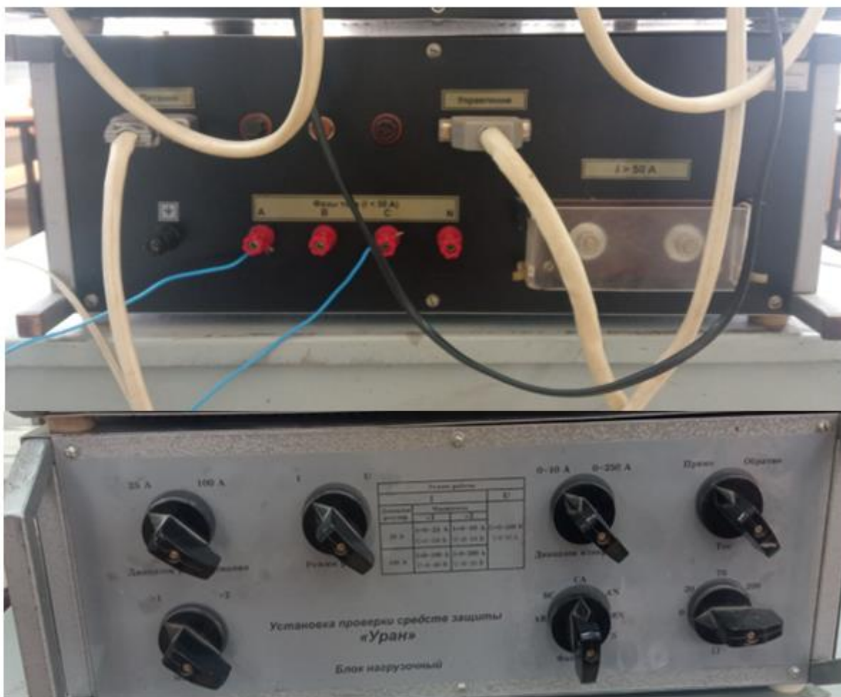
Рис. 2. Пример подключения нагрузочного блока
