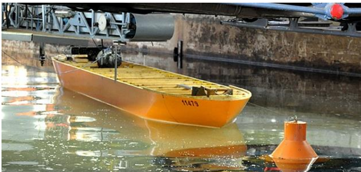
Рис. 1. Пример физического моделирования стационарного морского отгрузочного причала [2]
