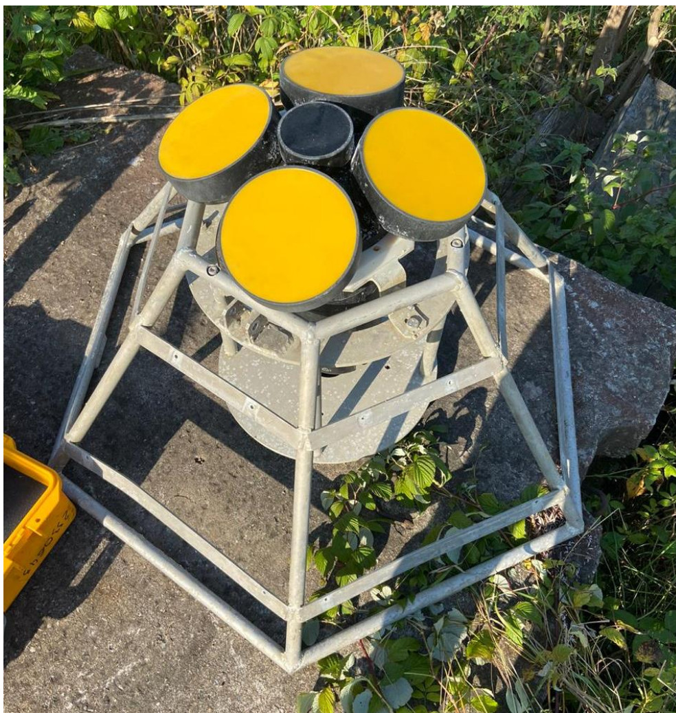
Рис. 10. Автоматическая донная станция, подготовленная к установке в акватории порта
