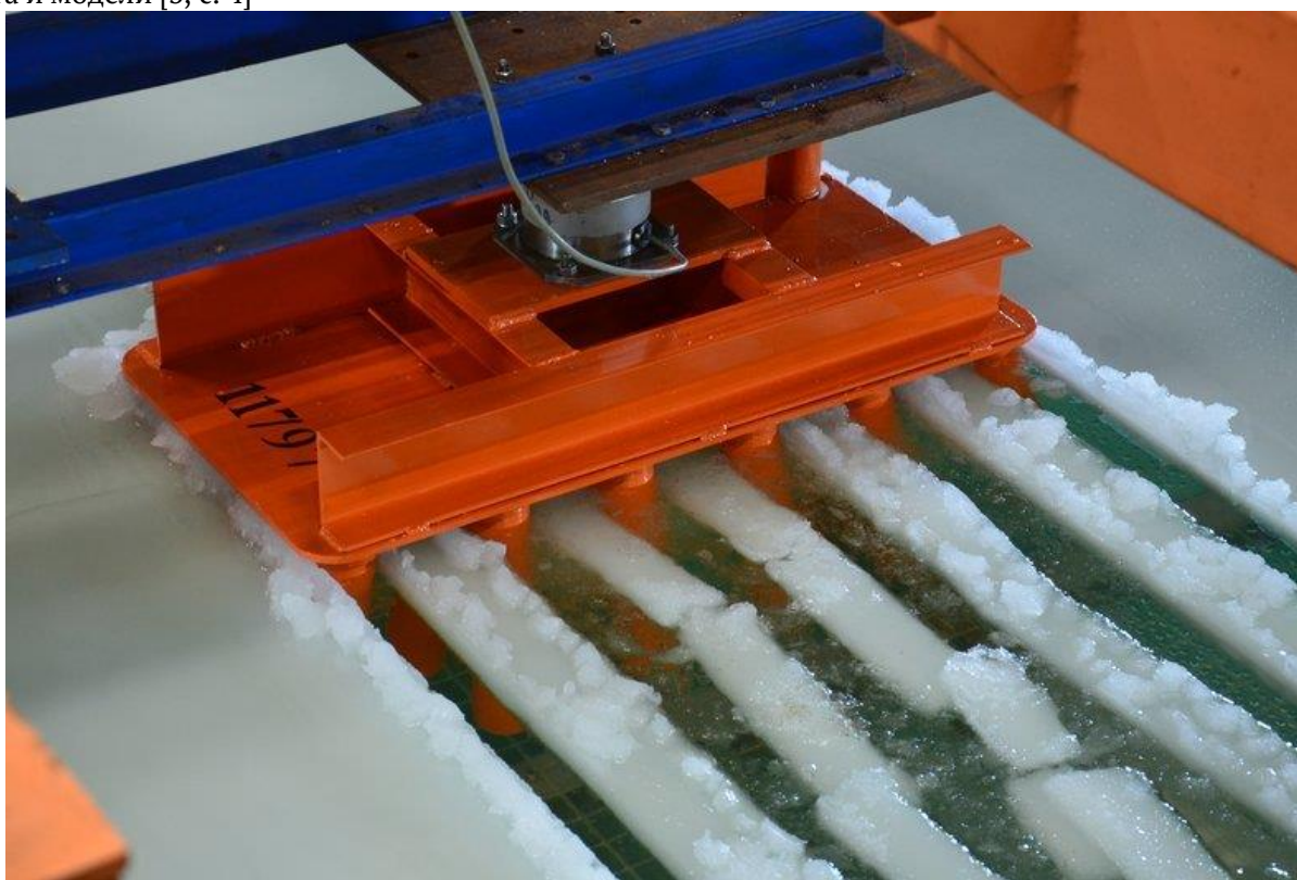
Рис. 2. Пример физического моделирования воздействия льда на искусственные сооружения [4]
