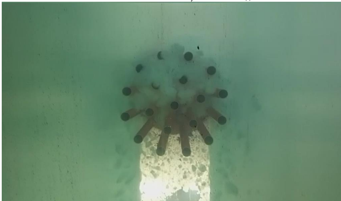
Рис. 3. Визуальное наблюдение процесса накопления льда в пространстве между палами при физическом моделировании взаимодействия гидротехнического объекта и дрейфующего ледяного поля
