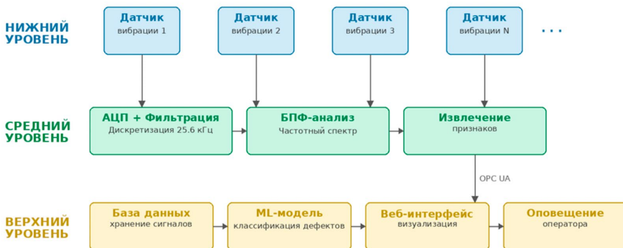
Рис. 2. Трёхуровневая архитектура системы вибромониторинга
