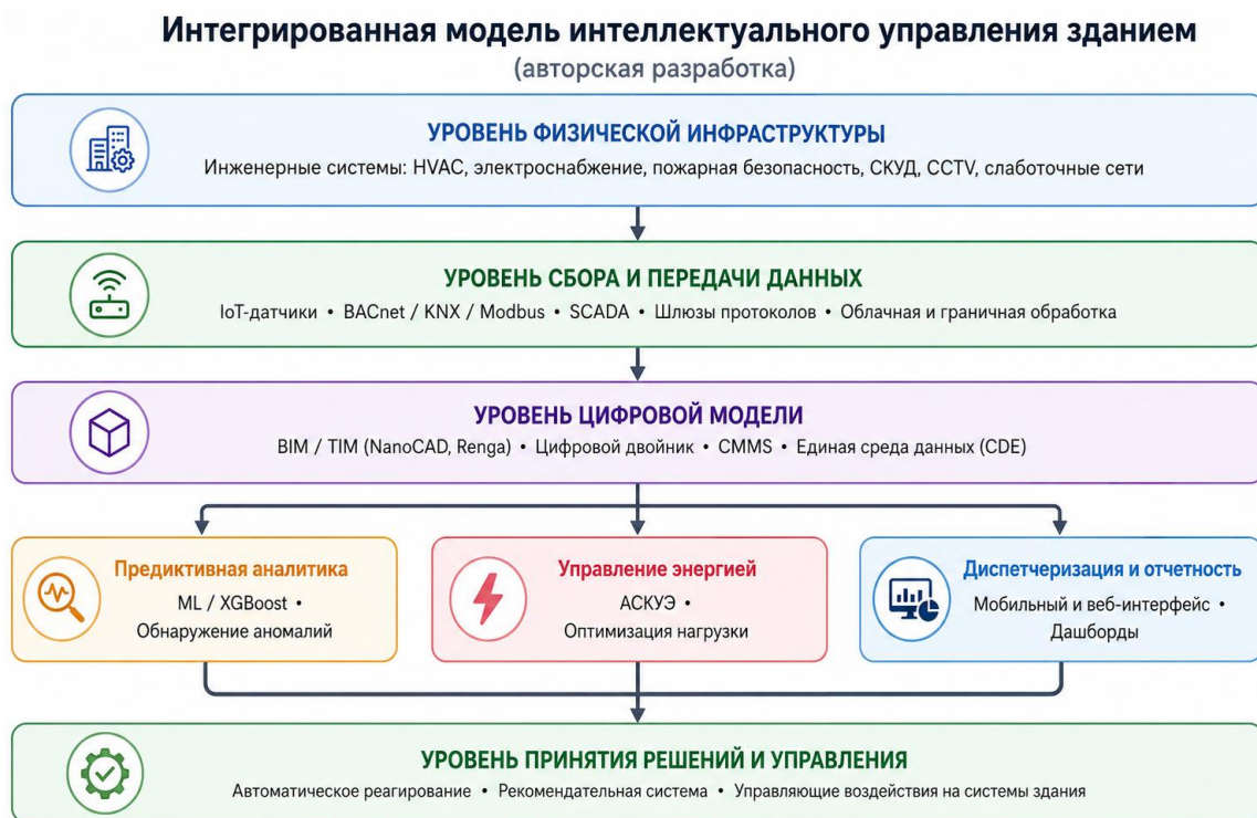
Рис. 3. Пятиуровневая интегрированная модель интеллектуального управления зданием (составлено автором на основе [5; 6; 9; 11; 13, с. 22-32; 16])
