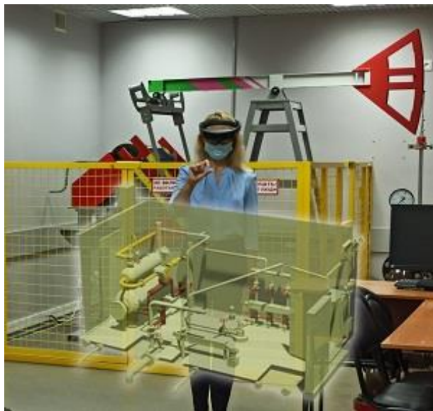
Рис. 2. Пример работы учебного AR-тренажёра ПАО АНК «Башнефть»
