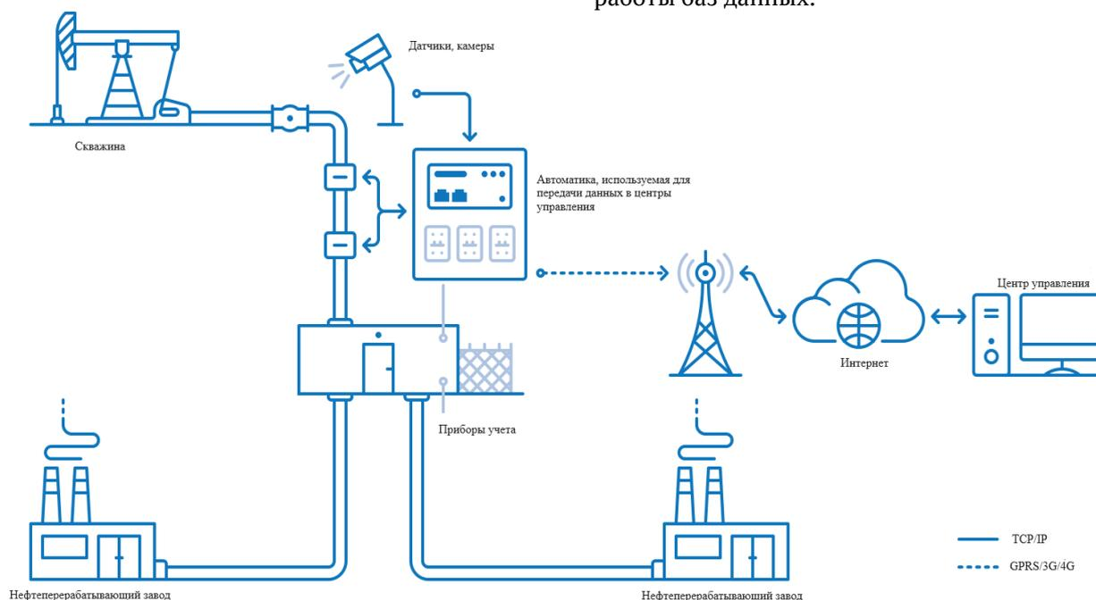
Рис. 4. Архитектура работы баз данных в нефтегазовом секторе
