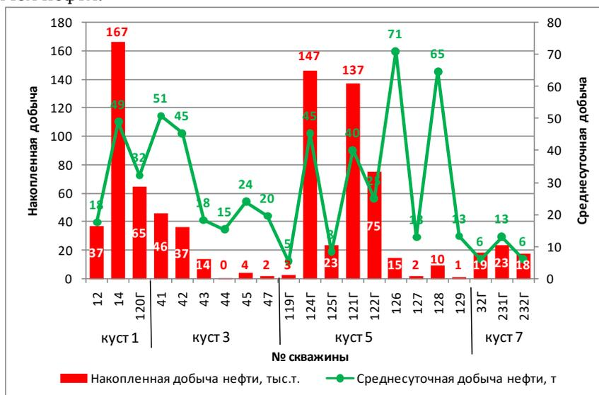
Рис. Распределение накопленной и суточной добычи нефти по ГС
