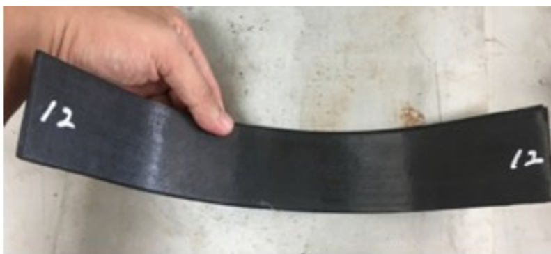
Рис. 3. Элемент шасси БПЛА из углепластика [4]
