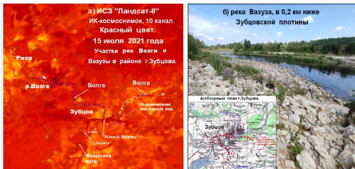
Рис. 15. Выклинивание грунтовых вод ниже плотины Зубцовского гидроузла.
