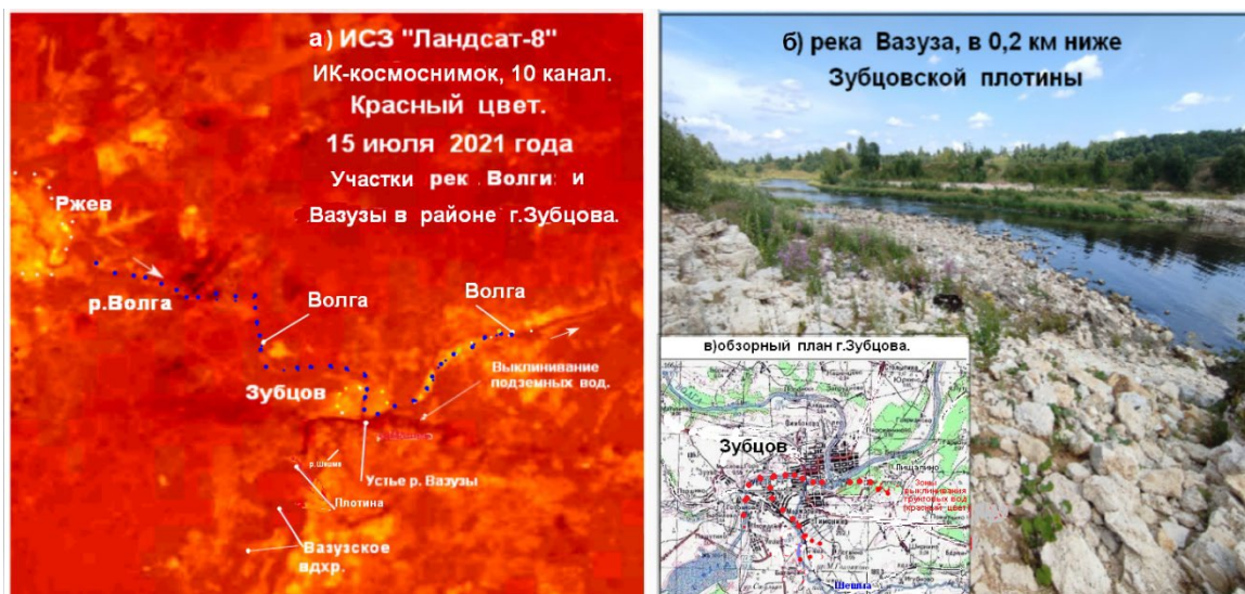
Рис. 15. Выклинивание грунтовых вод ниже плотины Зубцовского гидроузла.
