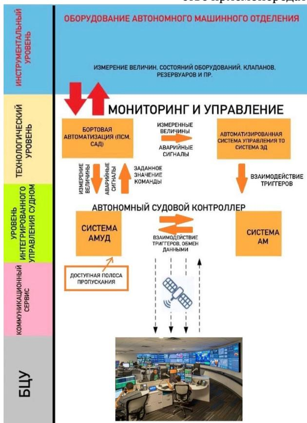
Рис. Структурное расположение АЕМС (АМУД) проекта «MUNIN»
