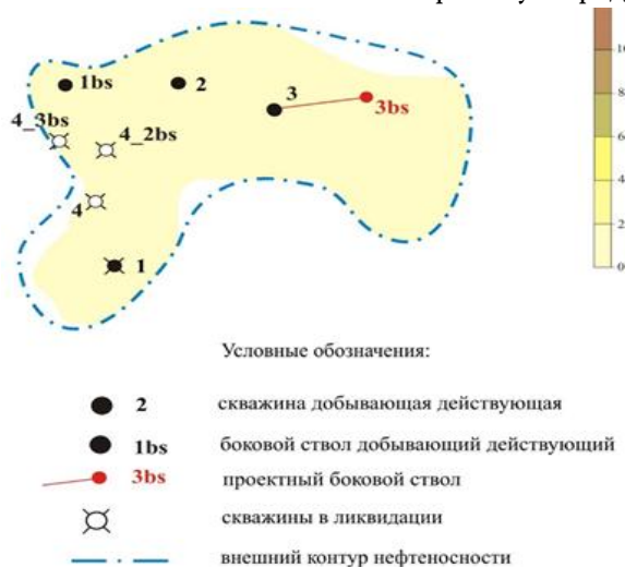
Рис. 5. Южно-Солнечное месторождение. Объект А4. Карта остаточных эффективных нефтенасыщенных толщин на последний год разработки. Вариант 2
