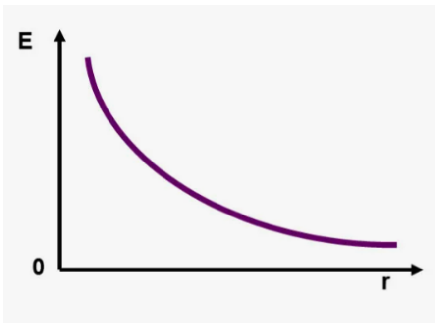
Рис. 3. Напряжённость электрического поля заряда
