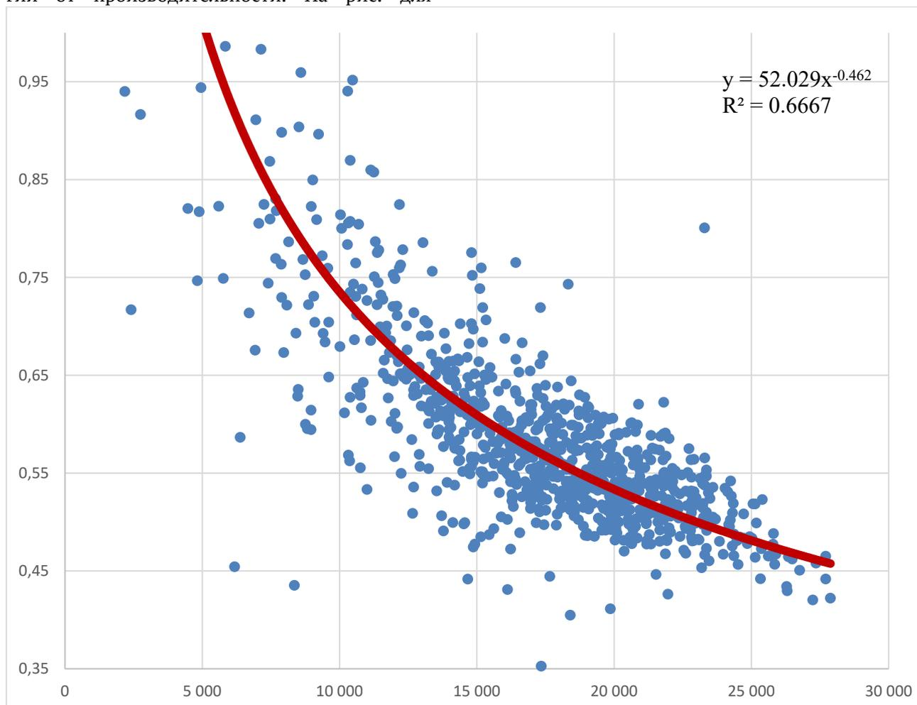
Рис. Зависимость УДН от производительности электрического экскаватора
