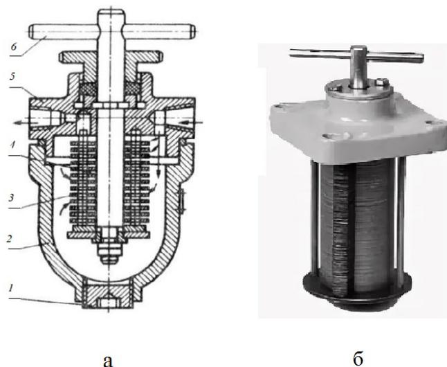
Рис. 3. Пластинчатый фильтр:
