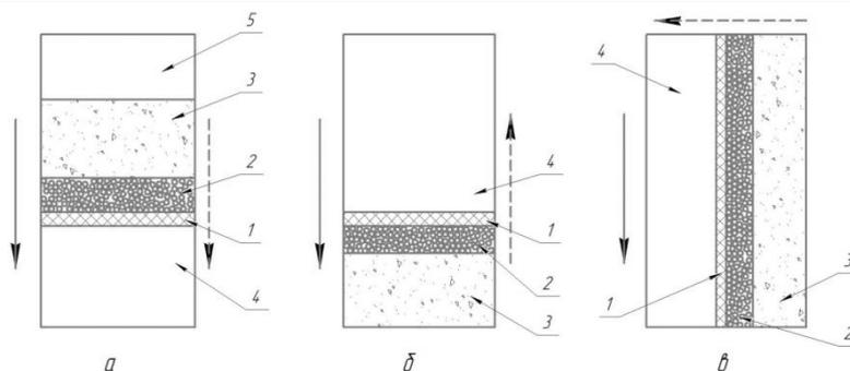
Рис. 1. Схема процесса фильтрации и взаимные действия силы тяжести и движения фильтрата: а – направления совпадают; б – направления противоположны; в – направления перпендикулярны; сплошные стрелки – направление действия силы тяжести; пунктирные стрелки – направления движения фильтрата; 1 – фильтровальная перегородка; 2 – осадок; 3 – суспензия; 4 – фильтрат; 5 – чистая жидкость
