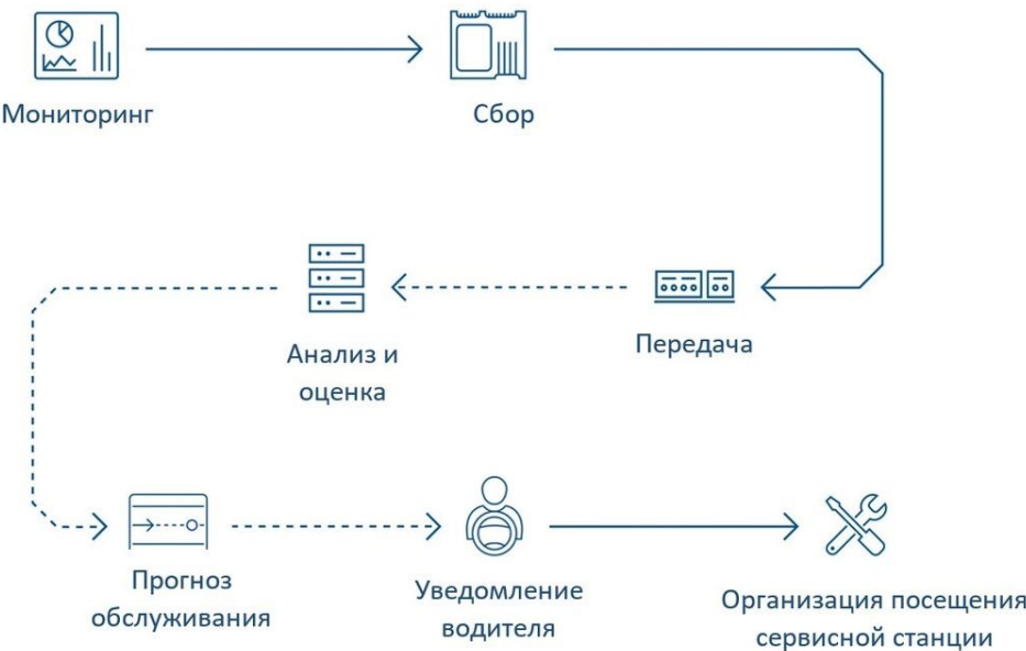
Рис. 2. Цикл предиктивного обслуживания на основе мониторинга, анализа и уведомлений
