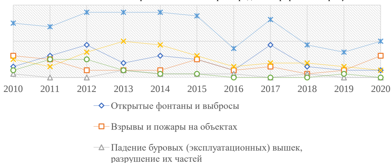
Рис. 1. Статистический анализ аварий в газодобыче и смежной отрасли (нефтедобыче) по частоте возникновения в динамике в динамике последнего десятилетия [2010/2020] (по данным Ростехнадзора)
