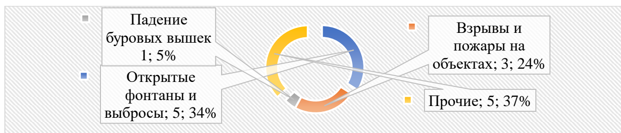
Рис. 2. Основные причины аварий в газодобыче и смежной отрасли (нефтедобыче) по медианному срезу в динамике в динамике последнего десятилетия [2010/2020] (по данным Ростехнадзора)
