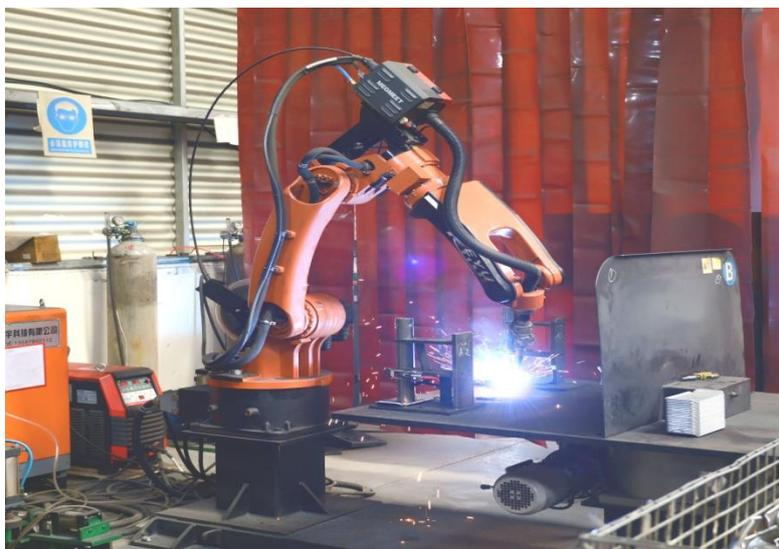
Рис. 1. Промышленный робот KR 6 R900
