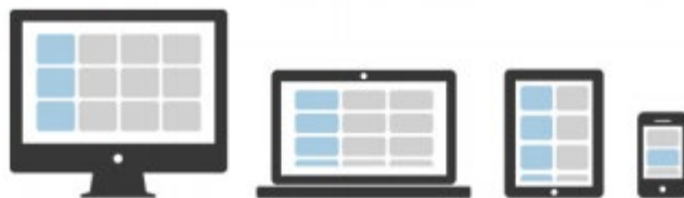
Рис. 4. Изменение сетки Bootstrap на устройствах с разным экраном
