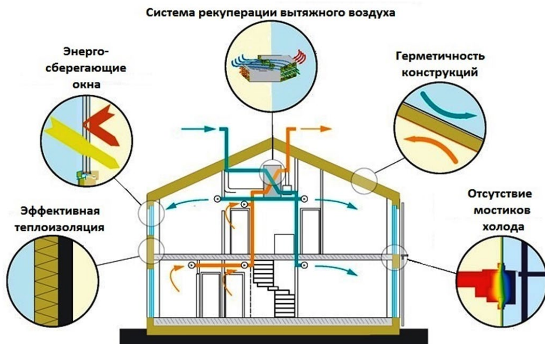
Рис. 2. Схема работы систем активного дома
