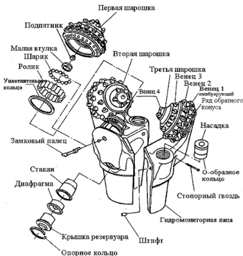
Рис. 2. Состав шарошечного долота
