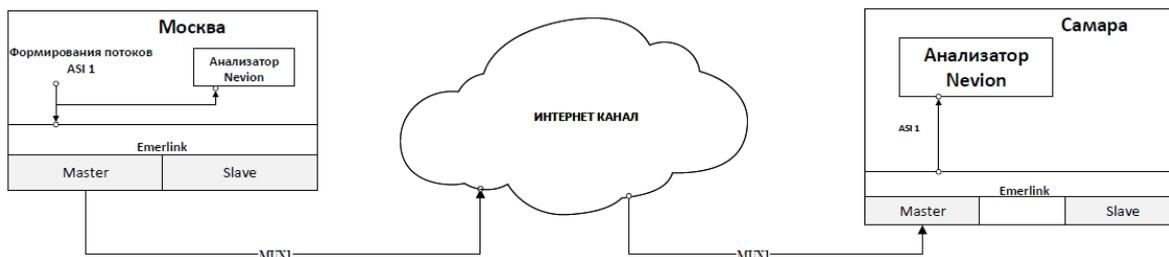
Рис. Схема проведения испытаний Москва (стример) – Самара (ресивер)
