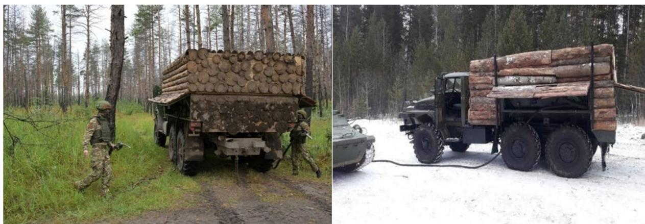
Рис. 2. Способы маскировки автомобильных топливозаправщиков
