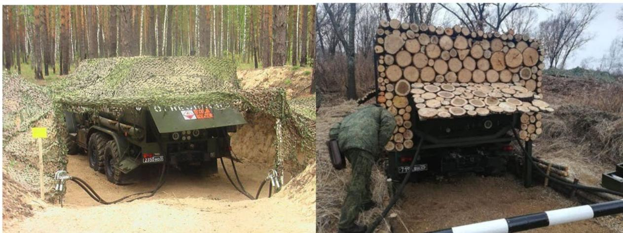
Рис. 1. Способы маскировки автомобильных топливозаправщиков
