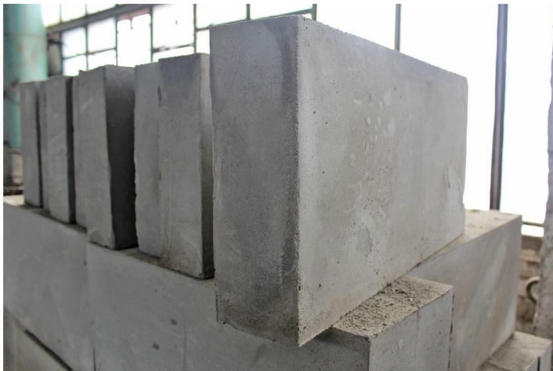
Рис. 7. Блоки из неавтоклавного газобетона
