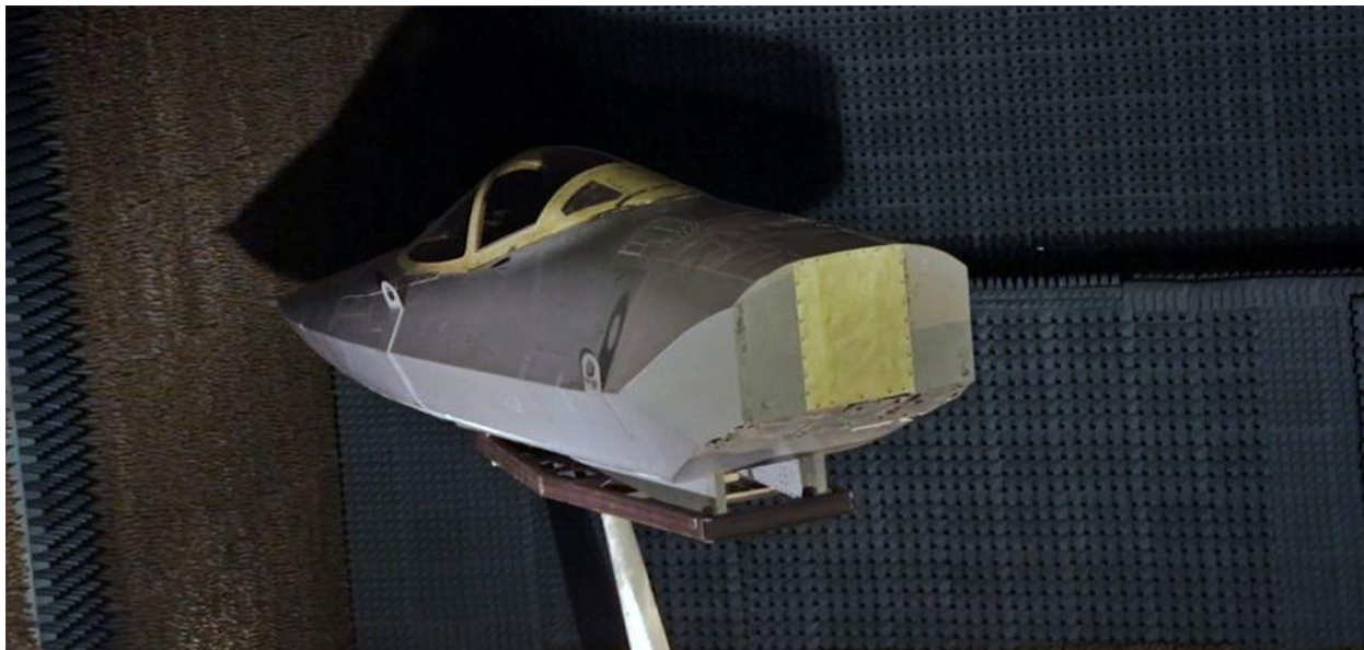
Рис. 2. Испытания фонаря кабины Су-57 на уровень ЭПР
