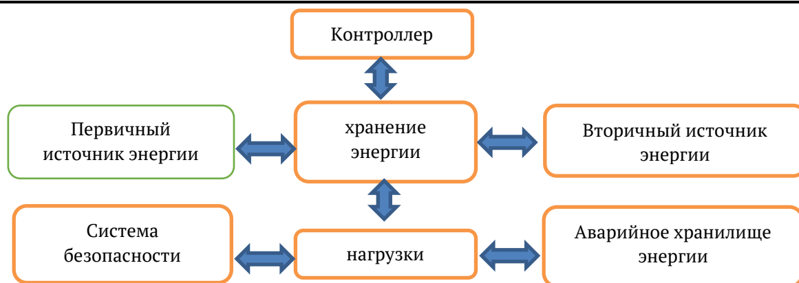
Рис. 1. Структурная схема Автономной энергосистемы (APS)
