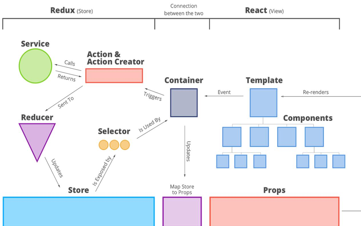
Рис. 1. Архитектура типичного фреймворка React-Redux
