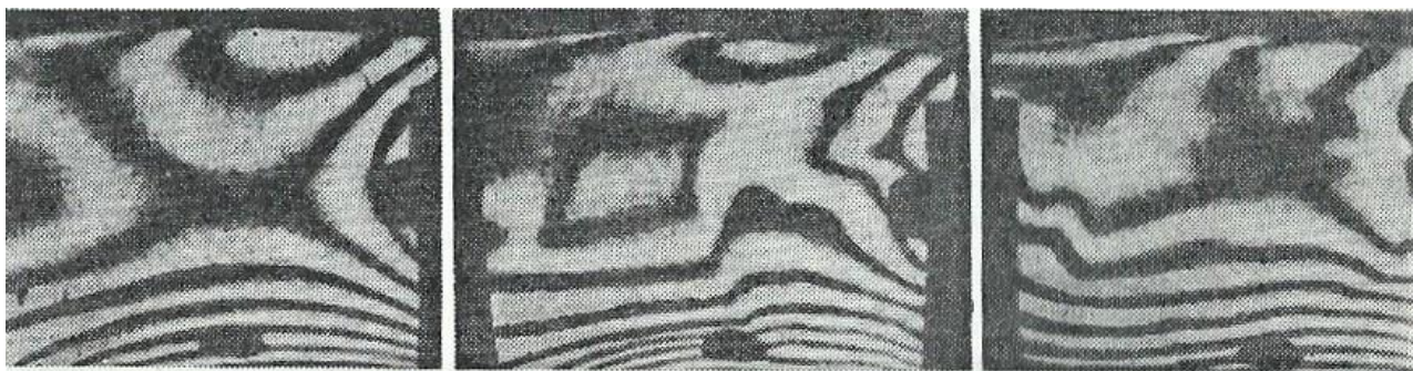
Рис. 3. Интерферограмма развития межфазной турбулентности и деформации пограничного слоя при абсорбции O_2 в водной среде с добавлением ПАВ №2 (фиксация изменения полос на фотографиях с дискретностью 5 сек.)
